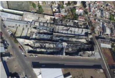
**5.-** 24 de abril, se acude a Ocotlán, a realizar la investigación relativa a un incendio que se generó en una bodega destinada para la construcción de muebles de madera, el siniestro se desarrolla a causa de un disturbio eléctrico con una propagación severa tanto en el inmueble como en los materiales que alojaba.
