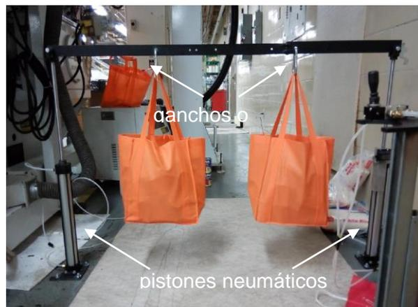
**Figura 1.** Equipo con pistones paralelos extendidos de forma neumática. Figura adaptada.<sup>3</sup>
