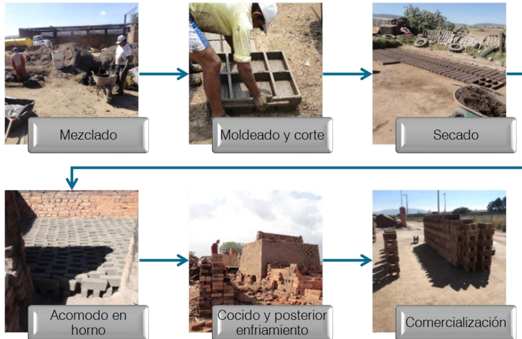
Figura 6.14: Proceso de producción de ladrillo Fuente: Elaboración propia, 2017.
