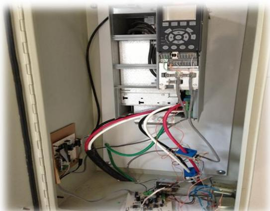
Fig. 8 Variador e interfaces de control
