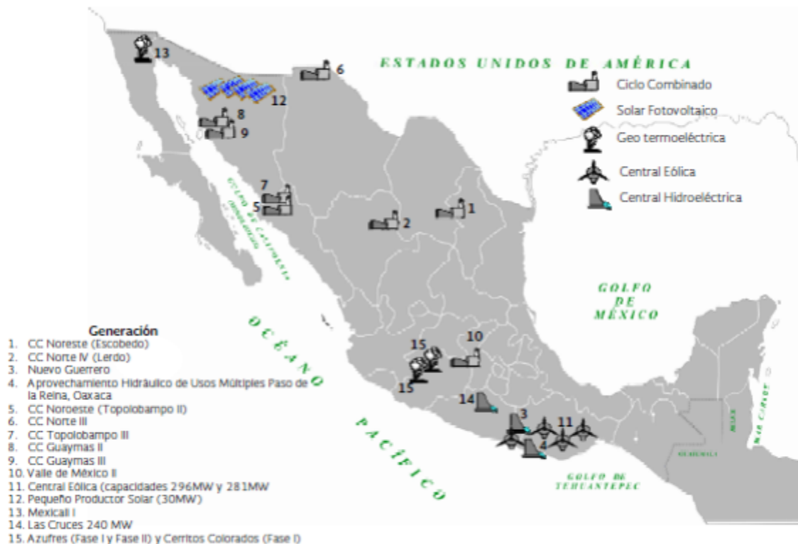
Figura 3.6 Principales proyectos de infraestructura de generación eléctrica
